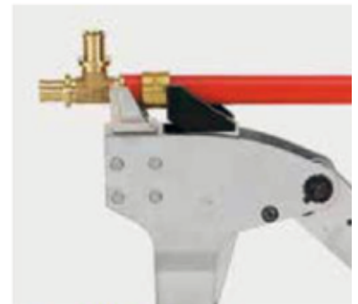
Manueller Aufschiebevorgang mit KSZ.
