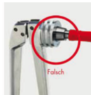
Rohr nicht vollständig auf Aufweitkopf aufgesteckt
